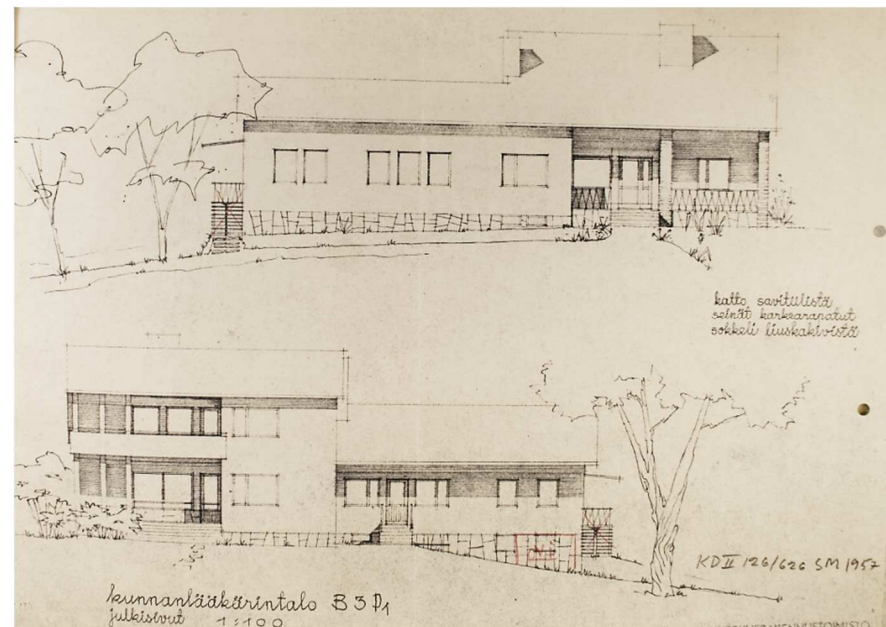
Kuva: Maaseudun keskusrakennustoimiston suunnittelema B3 P1 -tyypin kunnanlääkärintalo on kookas lähes 300 m 2 kivitalo, jossa korkea puoli on asuntona ja matalampi varattu vastaanottohuoneistolle. Asunnon sisäänkäynnit on vedetty rungon sisäpuolisille verannoille, vastaanottotiloihin käydään päätyseinästä ulkonevan, sadekatoksen suojaaman portaiden kautta. Savitiilikatto, karkearapatut tiiliseinät, liuskekivillä verhoiltu sokkeli ja verannan tukipilarit sekä muotoillut metallikaiteet ilmentävät vuosikymmenen materiaaliromanttista tyyli-suuntausta. / Virtasalmi, 1957. SAM:n arkisto, KA.
